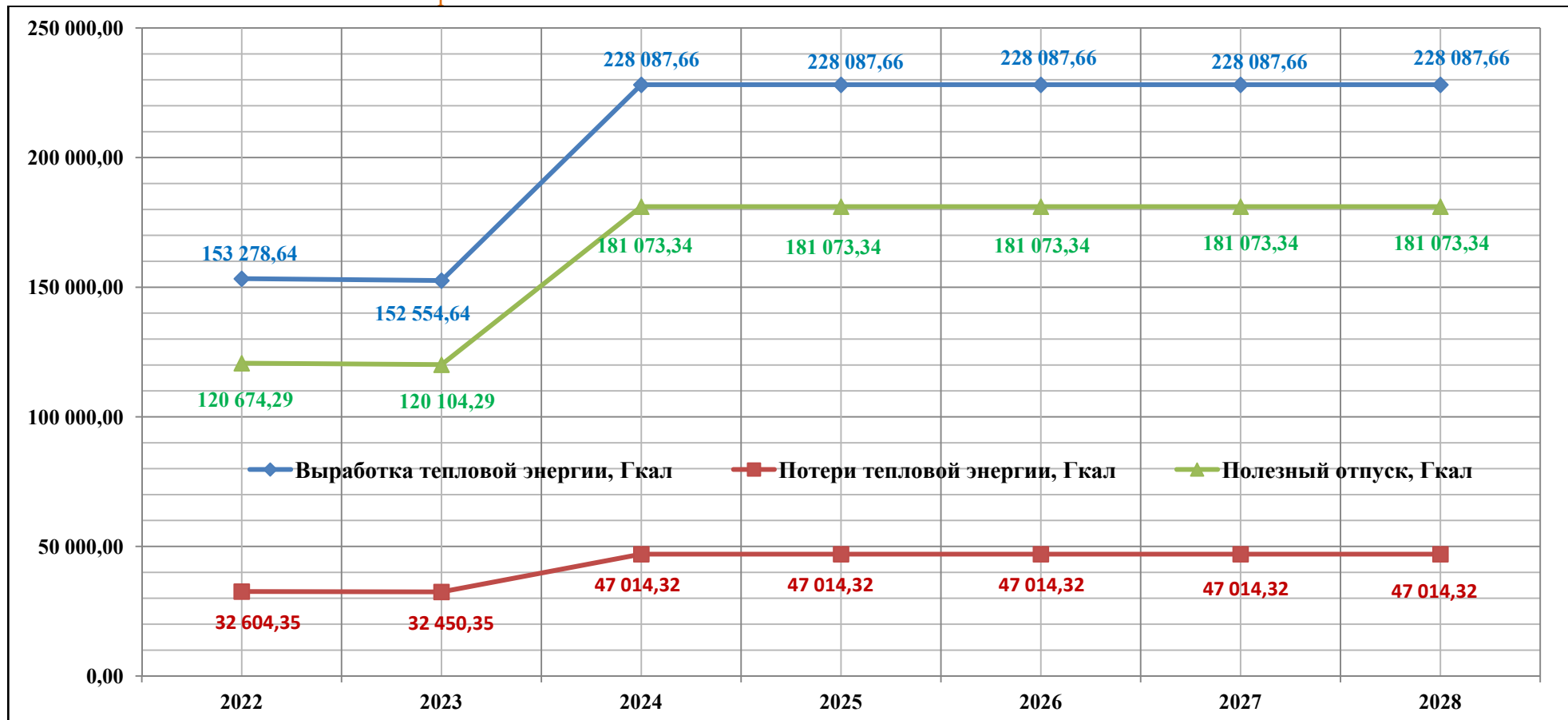
Рисунок №. 6 Соотношения выработки тепловой энергии, полезного отпуска и потерь тепловой энергии (мощности) на тепловых сетях для котельной №4 МУП «ЖКХ г. Лесосибирска»
