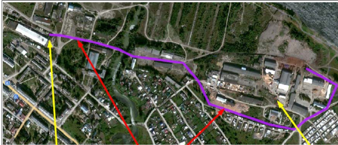
Рисунок №. 3 Схема прокладки теплотрассы до потребителей в район МЛДК
