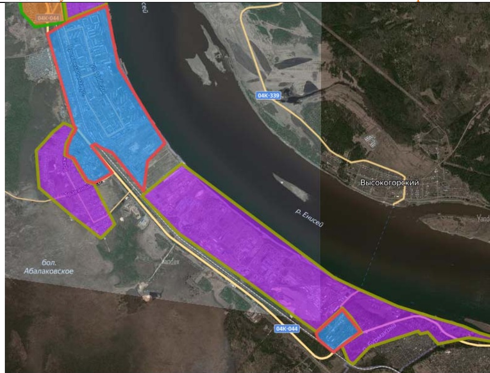
Рисунок №. 3 Существующие зоны действия производственного и индивидуального теплоснабжения в южной части г. Лесосибирска
