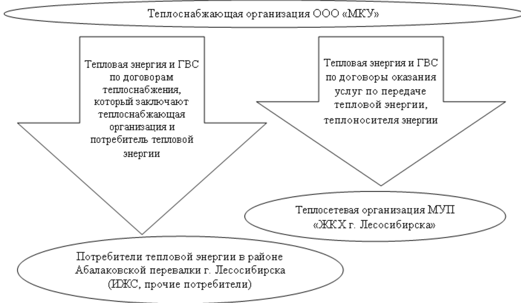
Рисунок №. 17 Структурная схема теплоснабжения потребителей в районе Абалаковской перевалки г. Лесосибирска
