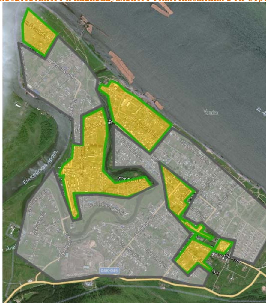
Рисунок №. 10 Зоны действия производственного и индивидуального теплоснабжения в гп Стрелка
