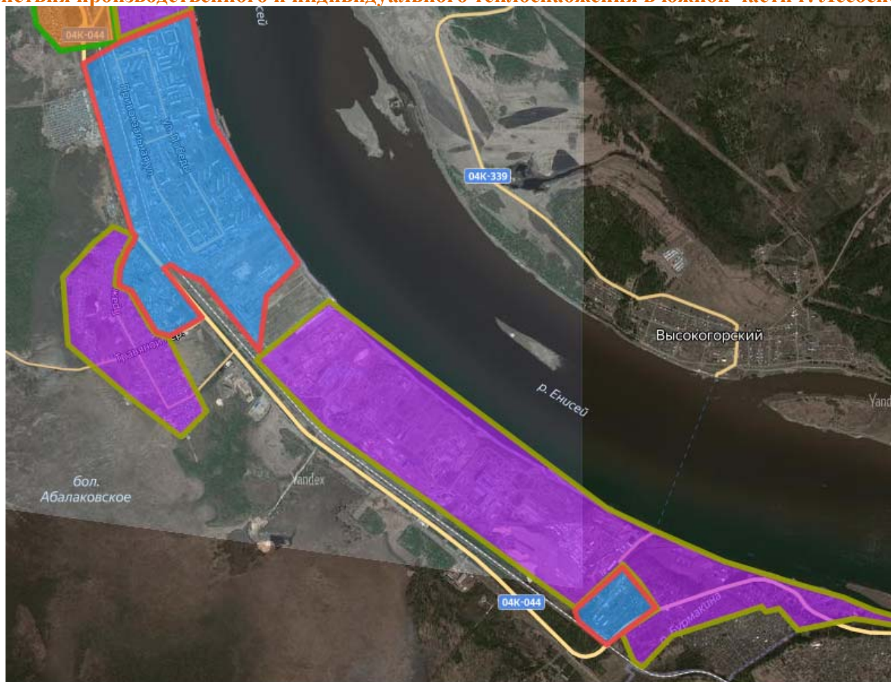
Рисунок №. 9 Зоны действия производственного и индивидуального теплоснабжения в южной части г. Лесосибирска
