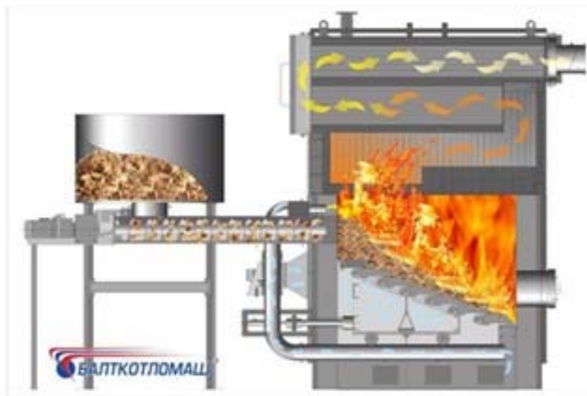
Рисунок №. 13 Схема работы котлового агрегата для МКУ-1 ООО «МКУ» в г. Лесосибирск
